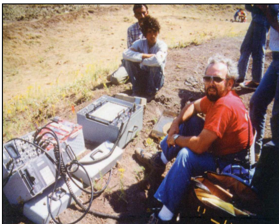
Tom Fenner se zemi pronikajícím radarem (GPR), navíc tam má kontrolní přístroj, záznamníky na magnetický pásek, grafické měřicí zařízení a baterie.
